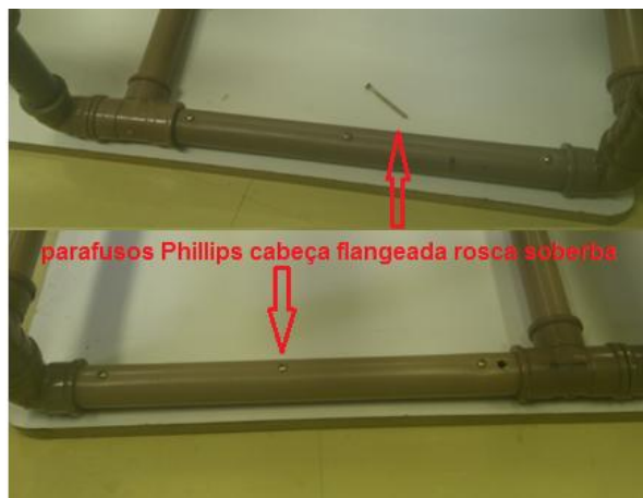
Figura 61. Fixação da chapa base - Passo 4
